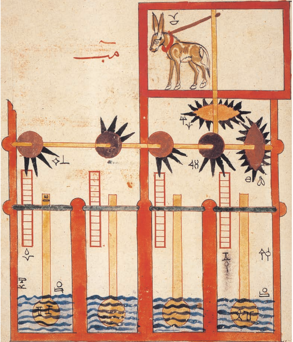
Şekil 3.6'da üzerinde bir dizi kovalar bulunan ve yine hayvan kuvveti ile çalışan bir su yükseltme cihazı
